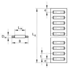
$L_K\pi = (d + D_w)$ (gestreckte Länge vor dem Rundbiegen) Flat length before bending
