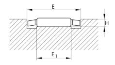
Toleranz für den Innenlaufbahn-Durchmesser: f6 Toleranz für den Außenlaufbahn-Durchmesser: H7 Tolerance inner race diameter f6 Tolerance outer race diameter H7
