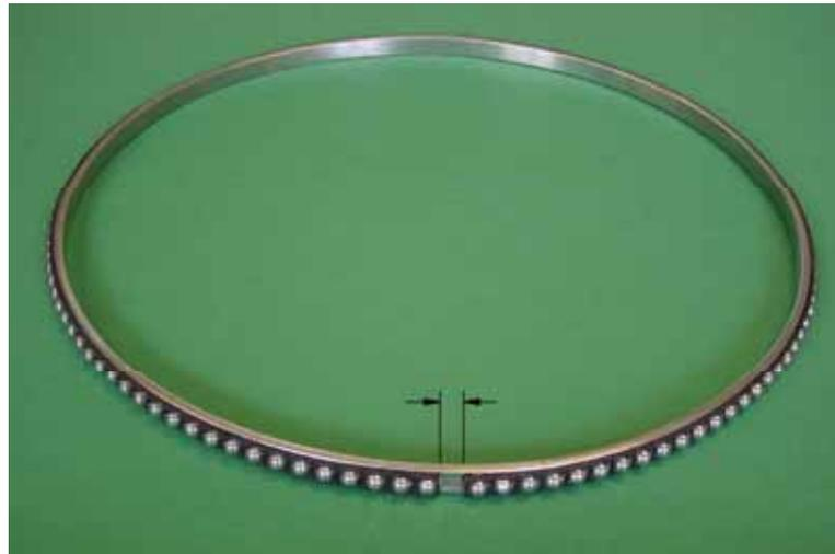
Auf Grund der unterschiedlichen Ausdehnungen von Kunststoffkäfigbändern und den umschließenden Lagerringen aus Stahl oder Leichtmetall müssen die Käfigbänder mit einem entsprechenden Endspiel eingesetzt werden. Für wälzkörperumschließende Käfigform empfehlen wir bei Temperaturdifferenz
