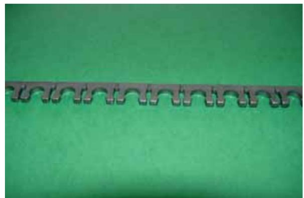
Kugelkäfigband Typ KK 101 (Schnappkäfig) Polyamid natur (links) und mit MoS<sub>2</sub> Zusatz (rechts)
