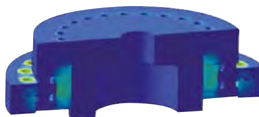
Fig. 2.4 Induced tension stresses Stato tensione indotto
